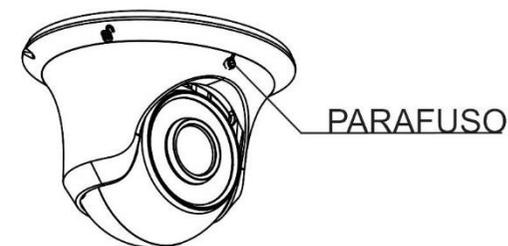
4. Fixe a base de fixação no teto ou parede apertando os parafusos firmemente.
